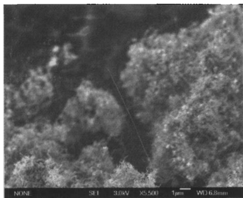
图 8 催化剂在 623 K 焙烧后制得的碳纳米管的 SEM 图
